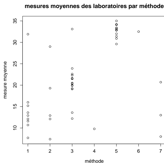
FIG. 4 – Essai inter-laboratoires n°2 : mesure de la teneur en aluminium sur des sédiments de rivière.
